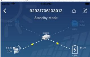
**[Modo de línea]** El inversor alimentará la carga desde la red pública con o sin carga fotovoltaica. Una empresa de servicios públicos calificada o una fuente fotovoltaica pueden cargar la batería.
