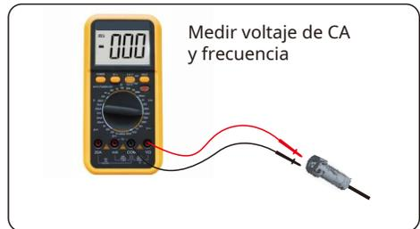
Paso 2: Encienda el OCPD del sistema y luego mida los voltajes de CA de línea a línea y de línea a neutro. El lado de respaldo del sistema estará apagado hasta que se complete la puesta en servicio. Apague nuevamente el OCPD por ahora.
